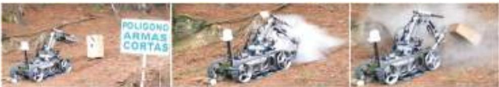
Figura 13 – Acercamiento del robot hacia el objetivo (izquierda). Disparo del cañón con carga de agua (centro). Ruptura del brazo por la explosión del cañón (derecha).
