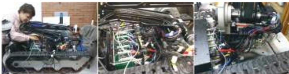
Figura 6 – Conexión manual de los diferentes sistemas en el robot (izquierda). Vista interna de la caja de control de motores (centro). Tráfico de cables que bajan del brazo manipulador a las cajas de control ubicadas en la plataforma móvil (derecha).
